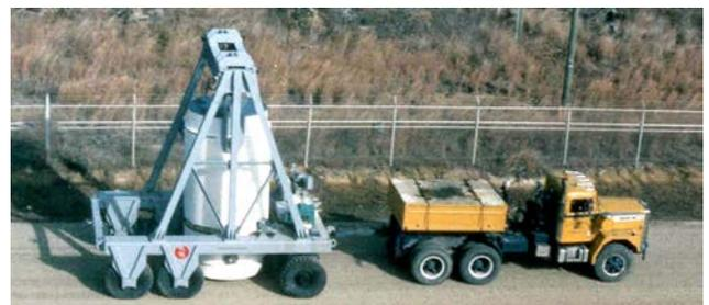
Transportador mueve barrica para el almacenamiento de combustible gastado cargada a la plataforma de almacenamiento.
