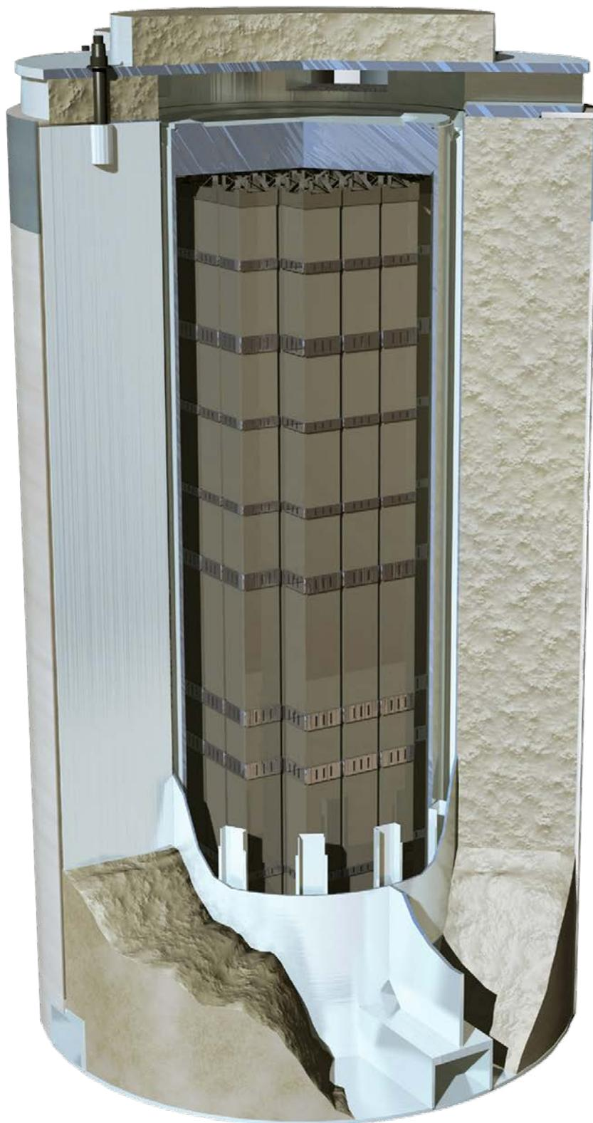
*Vista en corte de barrica para el almacenamiento de combustible gastado muestra los elementos de combustible gastado rodeados por acero y blindaje de hormigón grueso.*
