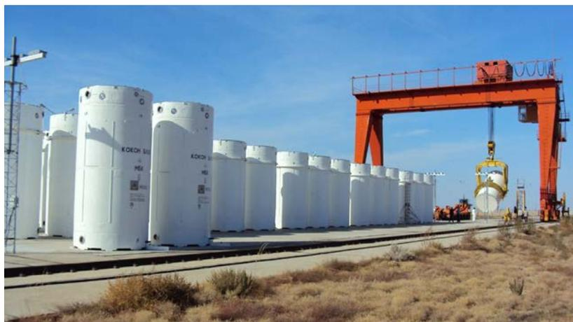
*Derecha, barrica de almacenamiento en seco recién cargada con combustible gastado es levantada de un transportador horizontal para ser colocada en una plataforma especialmente diseñada para el almacenamiento. (Cortesía de: Sandia National Laboratories)*
