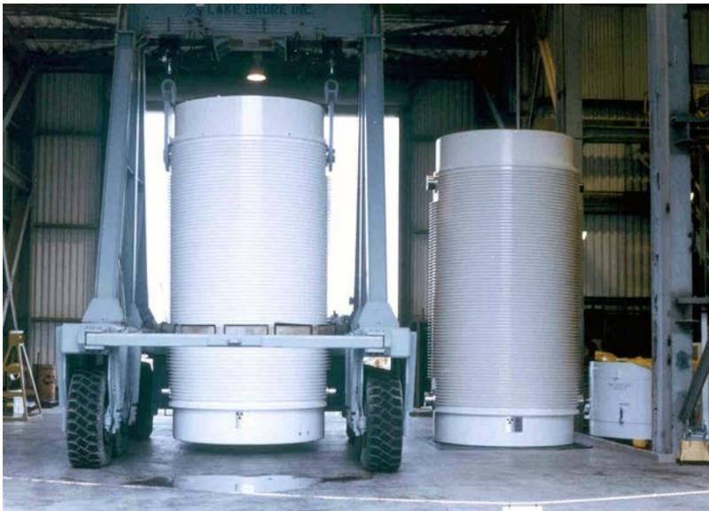
*Barricas de almacenamiento cargadas de combustible gastado en un transportador son trasladadas del edificio para el manejo del combustible en la Central Surry en Surry, VA.*
